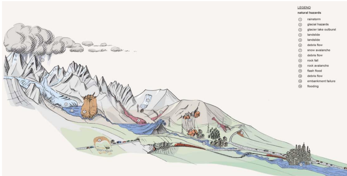
Verschiedene primäre und sekundäre Naturgefahrenprozesse, welche durch den Klimawandel im alpinen Raum verstärkt werden können. Die Figur zeigt die generelle Verknüpfung der verschiedenen Prozesse (Bildquelle: GEOTEST AG).
