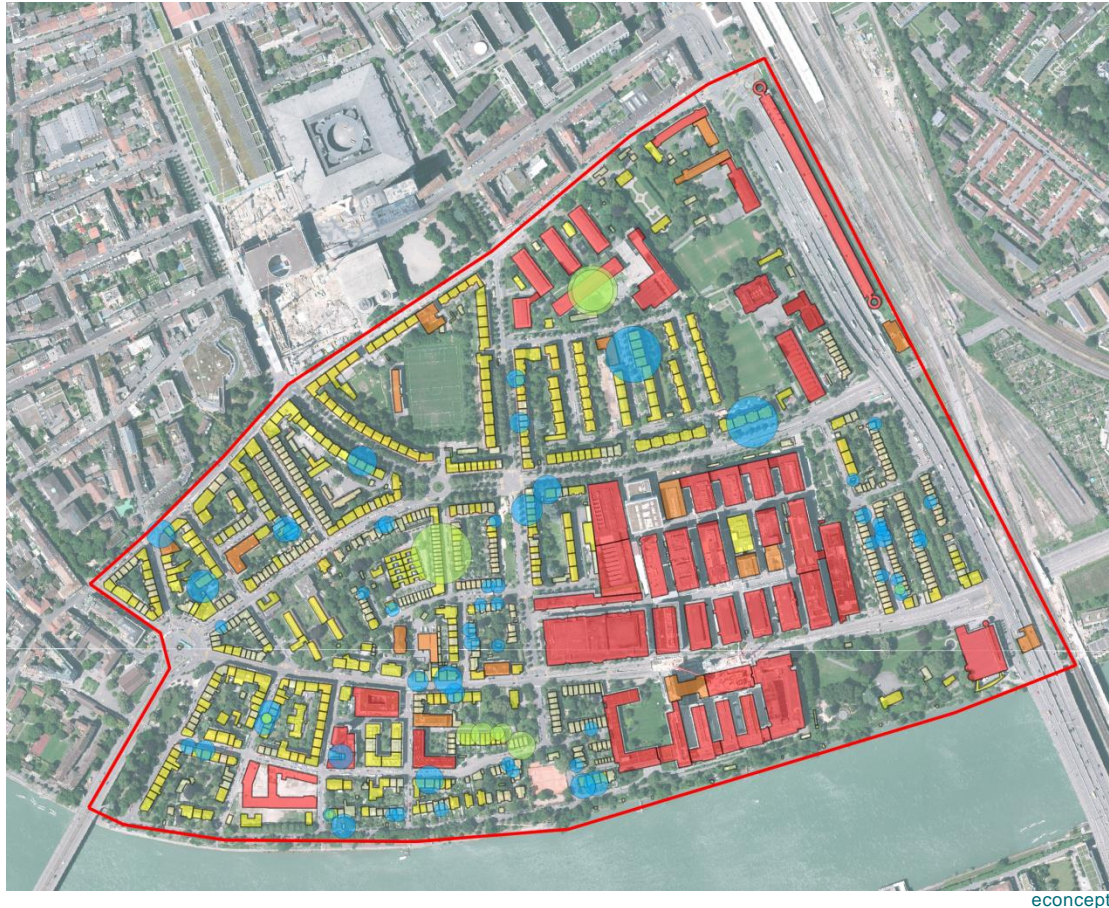
Figur 7: Kombination von Solarkataster und bereits installierten Photovoltaik- und Solarthermie-Anlagen. Das Solarkataster zeigt das PV-Potenzial auf den Dachflächen des Wettsteinquartiers (rot: Anlage > 100kWp; orange: Anlage 50-100 kWp; gelb: Anlage 10-50 kWp; hellgelb: Anlage < 10kWp), die installierten Photovoltaik-Anlagen sind grün, die Solarthermie-Anlagen blau eingezeichnet. Je grösser der Kreis, desto mehr Energie (kWh) erzeugt die bestehende Anlage pro Jahr.
